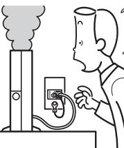
本製品は主電源コンセントの近くに設置し、遮断装置（電源プラグ）へ容易に手が届くようにしてください。
