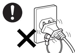
ACアダプタや電源プラグは、コンセントの奥まで確実に差し込み、不完全な接続状態で使用しないでください。
