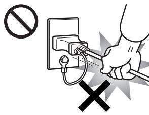
電源プラグを抜くときは電源ケーブルを引っ張らず、必ず電源プラグを持って抜いてください。電源ケーブルを引っ張ると、電源ケーブルの芯線が露出したり断線したり
