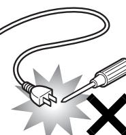
ACアダプタの電源プラグに、ドライバーなどの金属を近づけないでください。火災・感電の原因となります。
