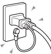
電源プラグをコンセントに差し込む前に、必ずアース線をコンセントのアースネジへ接続してください。
