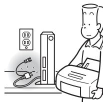
周辺機器の取り付けや取り外しを行うときは、パソコン本体および接続されている機器の電源を切り、電源プラグをコンセントから抜いた後に行ってください。
