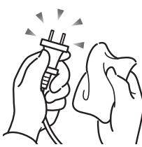
ACアダプタや電源プラグはコンセントからときどき抜いて、コンセントとの接続部分およびACアダプタと電源コードの接続部分などのほこりやゴミを乾いた布でよく拭き取ってください。
