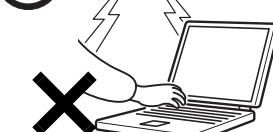
落雷の可能性がある場合は、あらかじめパソコン本体の電源を切り、その後電源コードをコンセントから抜き、ケーブル類を取り外しておいてください。
