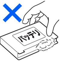
バッテリーパックや乾電池が液漏れし、漏れ出た液が万一、目や口に入ったときは、こすらず水道水などの多量のきれいな水で十分に
