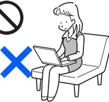
パソコン本体やACアダプタの温度が高くなる場所に長時間直接接触して使用しないでください。
