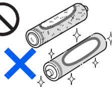
指定以外の乾電池は使用しないでください。また、新しい乾電池と古い乾電池を混ぜて使用しないでください。
