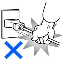
ACアダプタの電源プラグを抜くときは、電源コードを引っ張らず、必ず電源プラグを持って抜いてください。
