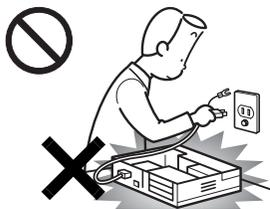
本体カバーを外した状態で電源プラグをコンセントに差し込んだり、電源を入れたりしないでください。
