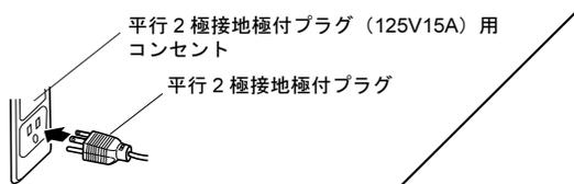
注：平行 2 極接地用口出線付変換プラグは使用しないでください。
