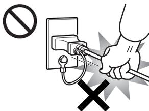
電源プラグを抜くときは電源ケーブルを引っ張らず、必ず電源プラグを持って抜いてください。電源ケーブルを引っ張ると、電源ケーブルの芯線が露出したり断線したり
