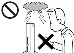
雷が鳴り出したときは、落雷の可能性がなくなるまでパソコン本体やケーブル類に触れないでください。ケーブル類の接続作業は、落雷の可能性がなくなるまで行わないでください。
