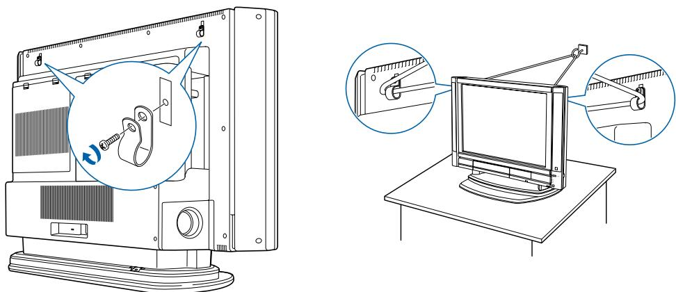
転倒防止用クランプは、パソコン本体背面の転倒防止用ネジ穴（2ヶ所）に、添付のネジで止めてください。その後丈夫なひもまたは鎖などで、固定してください。
