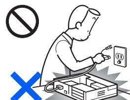
本体カバーを外した状態で電源プラグをコンセントに差し込んだり、電源を入れたりしないでください。感電・火災の原因となります。
