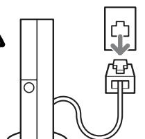
メモリの取り付けや取り外しを行うときなど、本体カバーをあける場合は、パソコン本体および接続されている機器の電源を切り、電源プラグをコンセントから抜いた後、しばらく経ってから本体カバーを開けてください。また、電話回線からモジュラーケーブルが接続されている場合、モジュラーケーブルも取り外してください。
