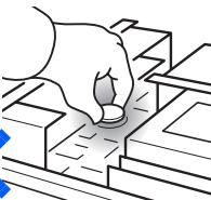
本パソコンの内部に搭載されているリチウム電池には触らないでください。
