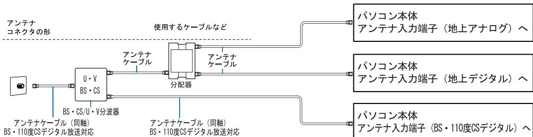
アンテナの確認・準備が完了したら、アンテナケーブルをパソコン本体に接続しましょう
