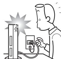
本製品を落としたり、カバーなどを破損したときは、パソコン本体の電源を切り、電源プラグをコンセントから抜いてください。
