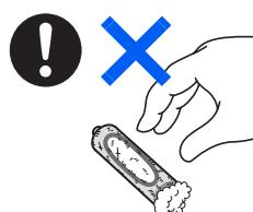
長時間使用しないときは、乾電池の液漏れを防ぐため、乾電池を取り出しておいてください。
