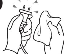
ACアダプタや電源プラグはコンセントからときどき抜いて、コンセントとの接続部分およびACアダプタと電源コードの接続部分などのほこりやゴミを乾いた布でよく拭き取ってください。
