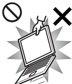
本装置を持ち上げたり運んだりする場合、液晶ディスプレイや液晶ディスプレイの枠部分を持って、装置を持ち上げたり運んだりしないでください。
