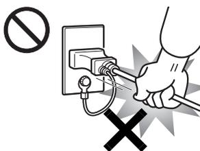
電源プラグを抜くときは電源ケーブルを引っ張らず、必ず電源プラグを持って抜いてください。電源ケーブルを引っ張ると、電源ケーブルの芯線が露出したり断線したりして、感電・火災の原因となることがあります。
