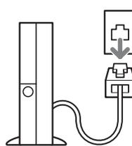
メモリの取り付けや取り外しを行うときなど、本体カバーをあける場合は、パソコン本体および接続されている機器の電源を切り、電源プラグをコンセントから抜いた後、しばらく
