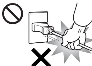
ACアダプタの電源プラグを抜くときは、電源コードを引っ張らず、必ず電源プラグを持って抜いてください。
