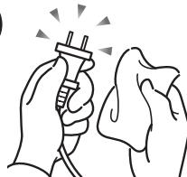
ACアダプタや電源プラグはコンセントからときどき抜いて、コンセントとの接続部分およびACアダプタと電源コードの接続部分などのほこりやゴミを乾いた布でよく拭き取ってください。
