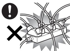
ACアダプタの電源プラグは、壁のコンセント(AC100V)に直接かつ確実にさし込んでください。また、タコ足配線をしないでください。
