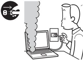
本製品から発熱や煙、異臭や異音がするなどの異常が発生した場合は、すぐにパソコン本体の電源を切り、ACアダプタの電源プラグをコンセントから抜いてください。
