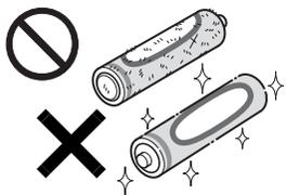
指定以外の乾電池は使用しないでください。また、新しい乾電池と古い乾電池を混ぜて使用しないでください。
