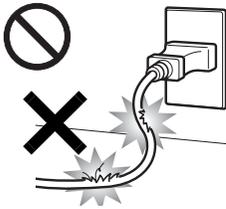
ACアダプタの本体やケーブル、電源コード、電源プラグが傷ついている場合は使用しないでください。火災・感電の原因となります。
