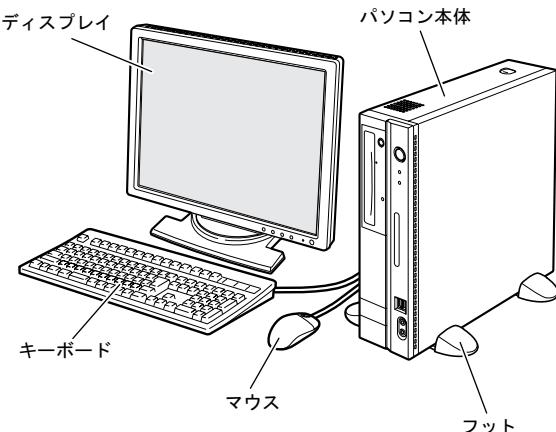
本パソコンを壁などに接して縦置きにする場合、壁などに接していない片側だけフットを取り付けます。
