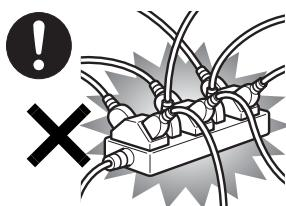
ACアダプタの電源プラグは、壁のコンセント(AC100V)に直接かつ確実に差し込んでください。また、タコ足配線をしないでください。
