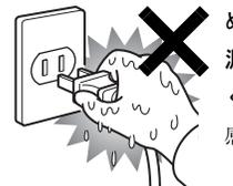
ぬれた手で AC アダプタの電源プラグを抜き差ししないでください。
