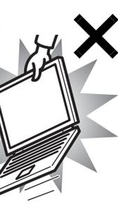
本装置を持ち上げたり運んだりする場合、液晶ディスプレイや液晶ディスプレイの枠部分を持って、装置を持ち上げたり運んだりしないでください。
