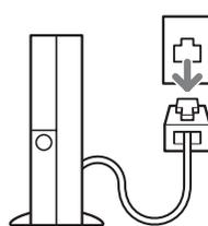
メモリの取り付けや取り外しを行うときなど、本体カバーをあげる場合は、パソコン本体および接続されている機器の電源を切り、電源プラグをコンセントから抜いた後、しばらく
