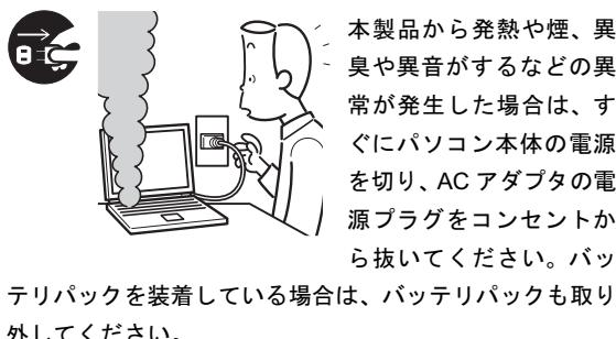
本製品から発熱や煙、異臭や異音がするなどの異常が発生した場合は、すぐにパソコン本体の電源を切り、ACアダプタの電源プラグをコンセントから抜いてください。バッテリパックを装着している場合は、バッテリパックも取り外してください。
