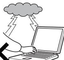
落雷の可能性がある場合は、あらかじめパソコン本体の電源を切り、その後電源コードをコンセントから抜き、ケーブル類を取り外しておいてください。
