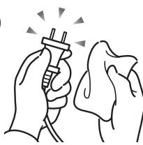
ACアダプタや電源プラグはコンセントからときどき抜いて、コンセントとの接続部分およびACアダプタと電源コードの接続部分などのほこりやゴミを乾いた布でよく拭き取ってください。
