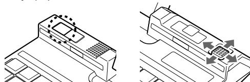
左ボタンを押しながら、希望の位置までステイックポイントを押します。ステイックポイントだけでドラッグする場合は、ステイックポイントをタップし、押し込んだままの状態で希望の位置まで上下左右に押します。
