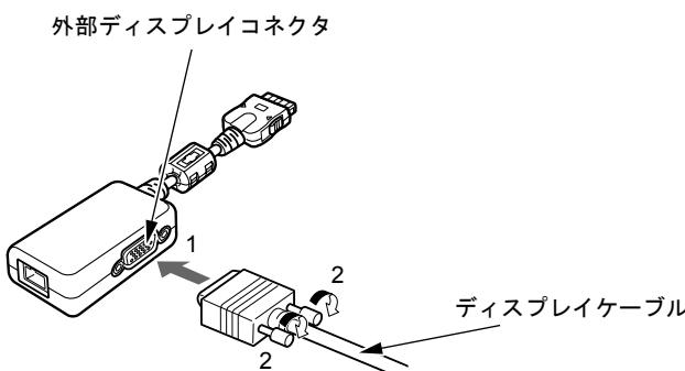
**3** パソコン本体前面のポートリプリケータ接続コネクタ／LAN/CRT 変換コネクタに変換ケーブル（LAN/CRT）を接続します。
