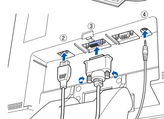
③ DVIケーブルを、ディスプレイ背面のDVIコネクタに接続します。接続後、コネクタの2つのネジを締めます。
