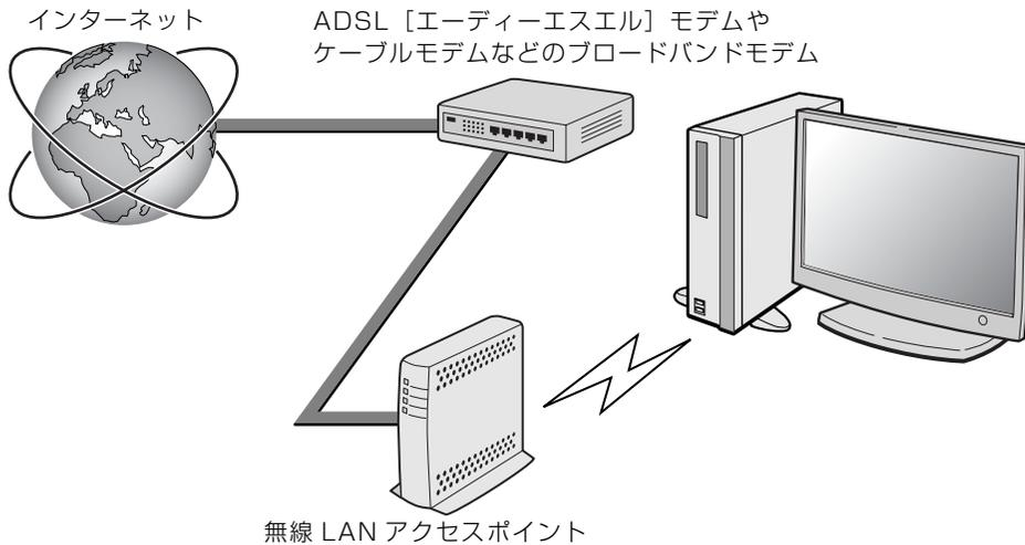
無線 LAN でインターネットに接続するには、無線 LAN アクセスポイントを利用する「インフラストラクチャ通信」という方式で通信します。
