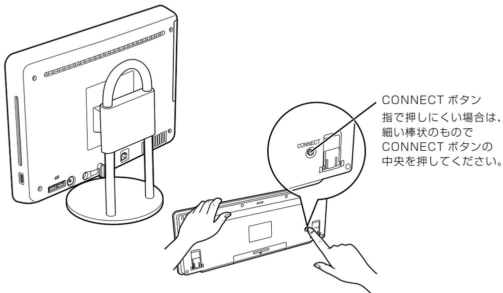
キーボード上面の状態表示 LCD のすべてのアイコンが点灯し、設定モードに入ります。
