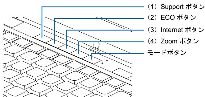
モードボタンを押すたびに、「Application」モードと「Player」モードが切り替わり、有効なモードのランプが点灯します。
