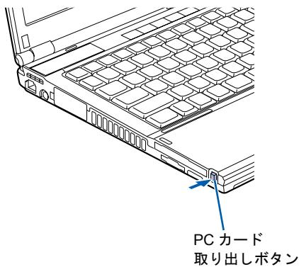
PC カード取り出しボタンが飛び出します。
