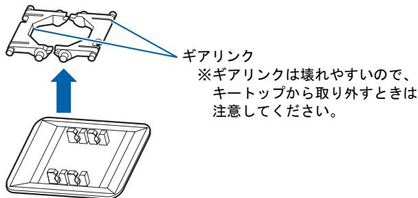
2 ギアリンクの平らな面を下にして、向きを確認してからキーボードに取り付けます。
