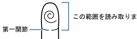
**2 指をまっすぐ伸ばして第一関節を指紋センサーに軽く当て、手全体を手前に引くようにしてセンサー部が完全に見えるまで水平にスライドさせます。**
