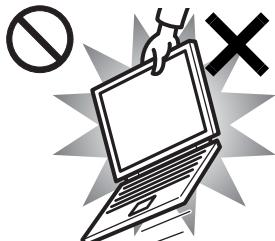
本装置を持ち上げたり運んだりする場合、液晶ディスプレイや液晶ディスプレイの枠部分を持って、装置を持ち上げたり運んだりしないでください。
