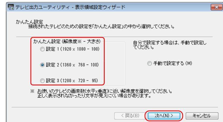
一覧に設定したい値が表示されない場合は、「手動で設定する」の  をクリックして  にし、画面の指示に従って手動設定してください。
