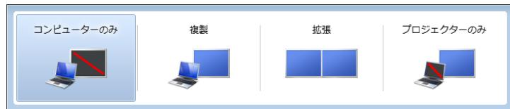
2つのキーを押すごとに、「コンピューターのみ（液晶ディスプレイ表示）→複製（液晶ディスプレイと外部ディスプレイの同時表示）→拡張（液晶ディスプレイと外部ディスプレイのマルチモニター表示）→プロジェクターのみ（外部ディスプレイ表示）…」の順でディスプレイ表示方法を選ぶことができます。
