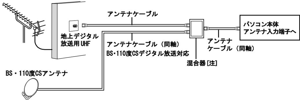
注: BS・110度CSアンテナに電源を共有する場合の混合器は、電流通過タイプを使用してください。
