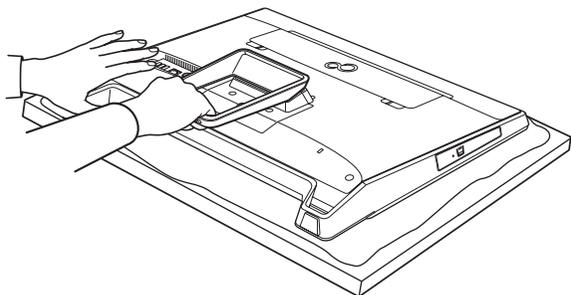
作業は厚手の柔らかい布を敷いた平坦な台の上でしてください。特に、液晶ディスプレイに突起物があたらないようにしてください。
