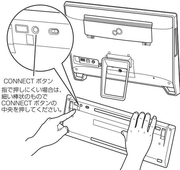
状態表示ランプが点滅から点灯に変わり、約 2 秒後に消灯します。
