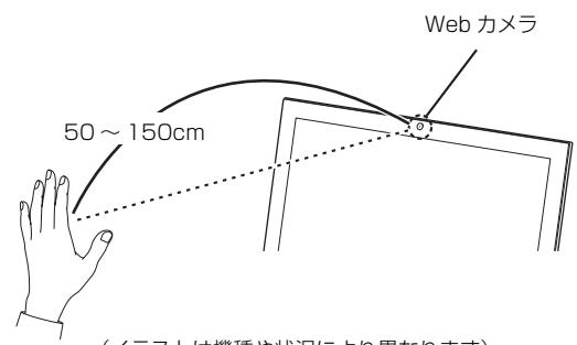
●手がうまく認識されない場合は、次の手順でチュートリアルウィンドウを表示し、手をかざす位置を調整してください。
