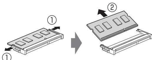
下段にあるメモリスロットのメモリを交換する場合は、上段にあるメモリスロットのメモリを先に取り外してください。
