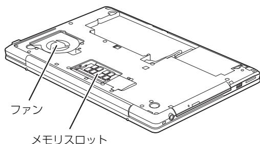
下段にあるメモリスロットのメモリを交換する場合は、上段にあるメモリスロットのメモリを先に取り外してください。
