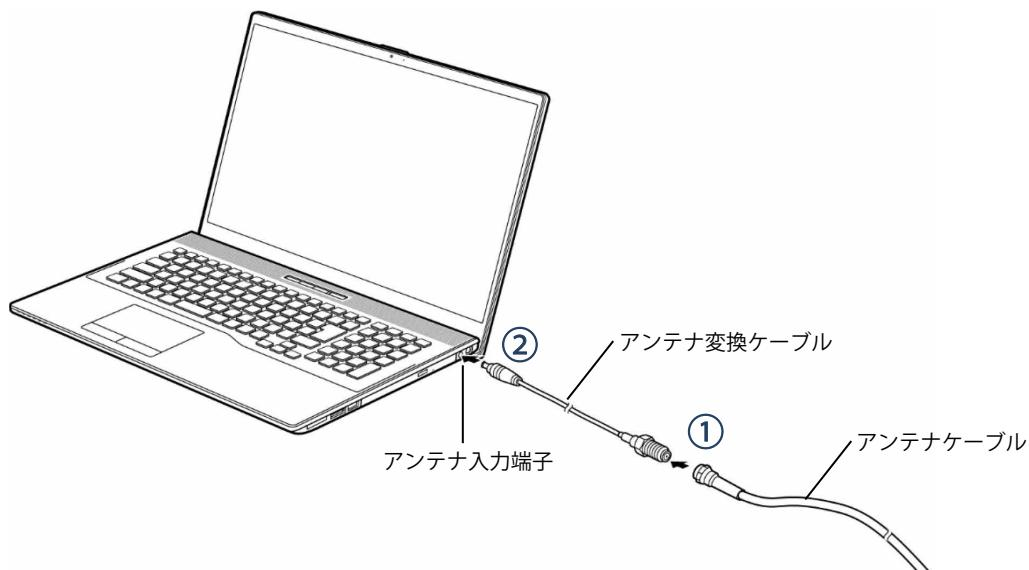
①パソコンに添付されているアンテナ変換ケーブルのアンテナ端子側に、アンテナケーブルを接続します。
