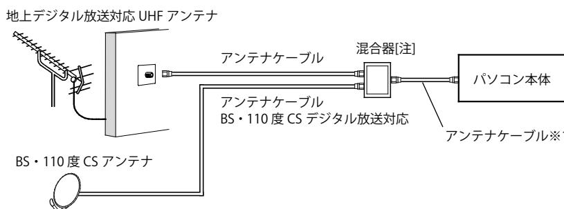
注：BS・110度CSアンテナに電源を供給する場合は、電源通過タイプの混合器を使用してください。
