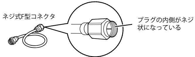
アンテナケーブルとパソコンの接続には、ノイズの影響を受けにくいネジ式のF型コネクタプラグ付アンテナケーブルの使用をお勧めします。
