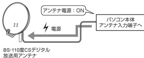
「DigitalTVbox」のテレビ画面をクリックして操作パネルを表示し、◀▶⚙️▶「テレビ設定」▶「チューナー／アンテナ」の順にクリックし、「アンテナ電源（LNB電源）設定」の設定を「ON」に変更してください。
