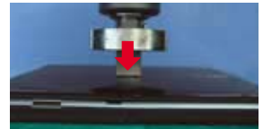
天板からの一点加圧試験 (約35kgを再現して天板全体に実施)
